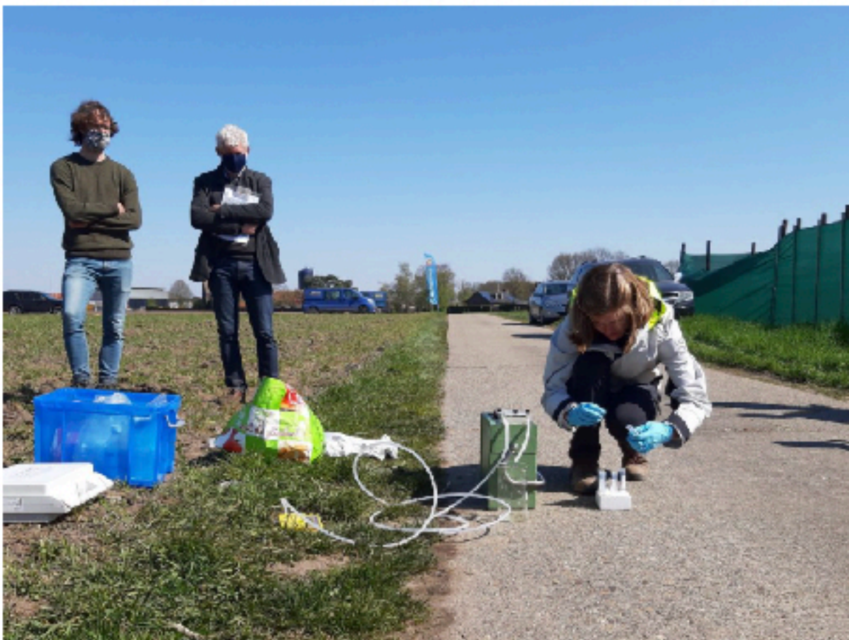
Het subirrigatiesysteem, bestaande uit infiltrerende buizen wordt aangelegd. De VUB neemt stalen van het grondwater om de kwaliteit op te volgen.
